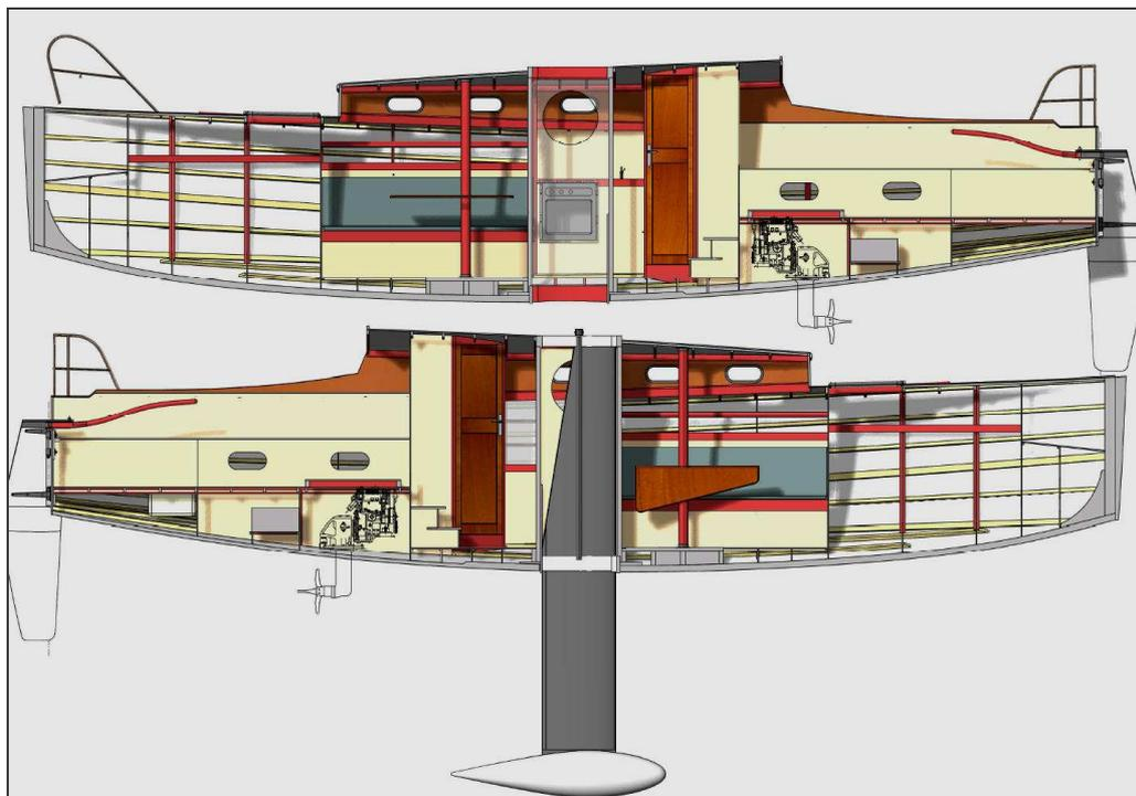
Le lest pèse 1875 kg dont 1600 kg de plomb. Le système de relevage est maintenant bien rodé avec deux vérins hydrauliques de part et d'autre du voile de quille. Les pompes hydrauliques du commerce utilisées sur les petits camions sont largement suffisantes.
